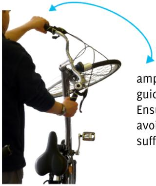
amplitude maximale. Si vous sentez de la résistance lorsque vous tournez le guidon, il vous faudra sûrement changer les roulements du jeu de direction. Ensuite, replacez le vélo sur ses deux roues et freinez sèchement. Il ne doit y avoir aucun jeu dans la direction. Toutefois, un resserrage simple peut parfois suffire à résoudre le problème.
